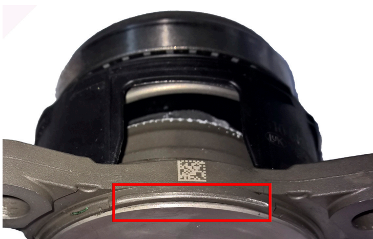
Foto 2: Uszkodzony wysprzęglik z rozwarstwionym uszczelnieniem
