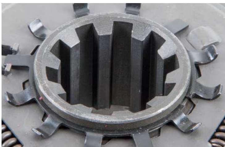
Foto 2: Piasty fosforowane powinny być posmarowane
