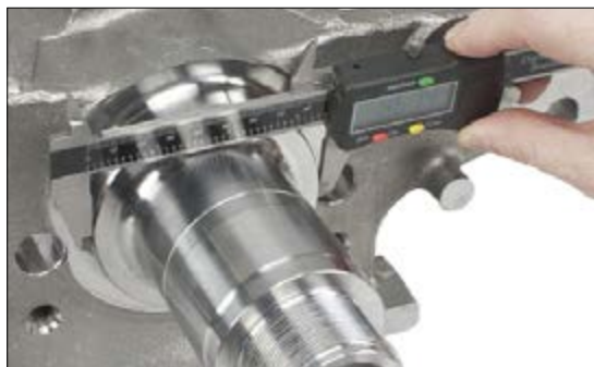
Foto 2: W celu określenia, który z trzech pierścieni ochronnych powinien być zamontowany, należy zmierzyć czło piasty
