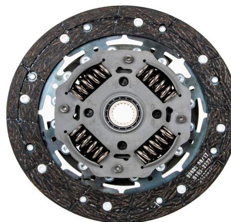
Foto 2: Tarcza sprzęgła LuK z wahadłowym tłumikiem drgań CPA (widok od strony skrzyni biegów)
